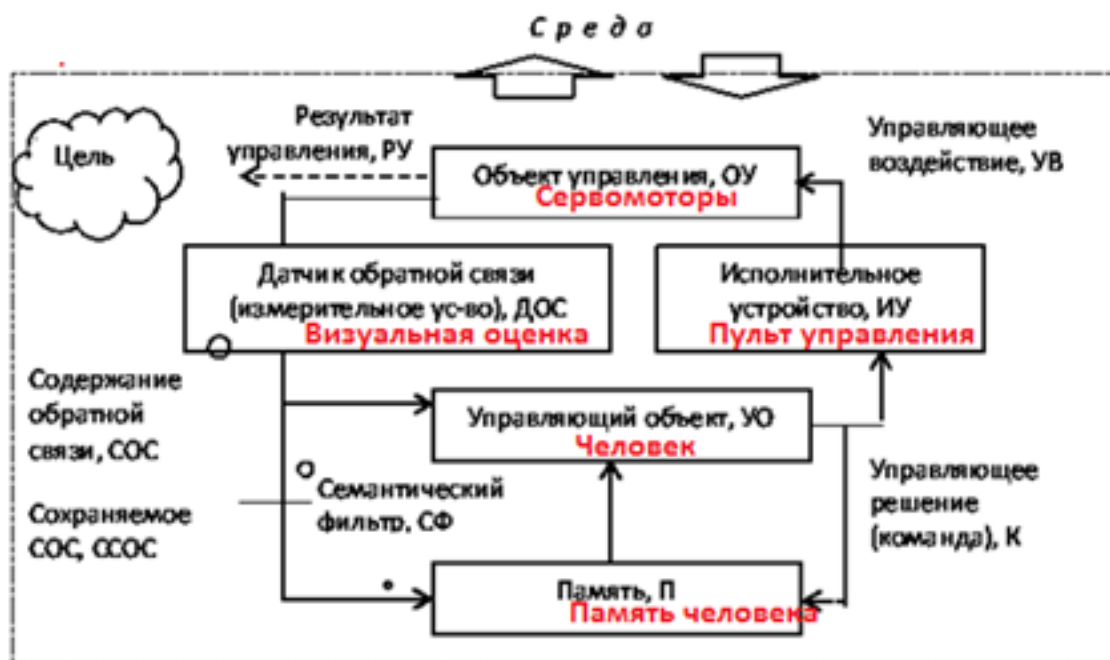
Рисунок 2. Обобщенная схема системы управления в случае управления роботом человеком
