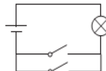
Рис. 3.6. Электрическая схема модели логического элемента «ИЛИ» и ее реализация в компьютерном конструкторе «Начала электроники»
